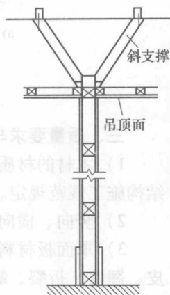
图1-4 有门木隔断墙与建筑顶面的固定
