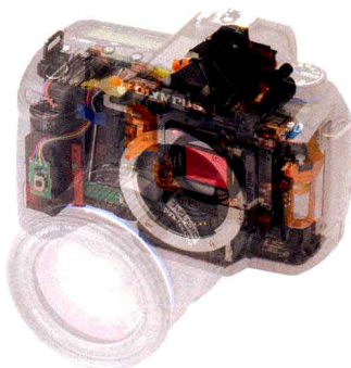
▲若透视 E-620 的内部，便会发现 D-SLR 的成名组件反光镜和五棱镜，在底部的高速 AF 组件亦是透过反光镜等的结构运作。
