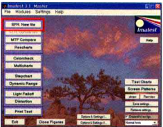
▲测试使用电脑软件Imatest v3.1 Master作数据分析，测试项目为SFR (Spatial Frequency Response)，得分单位为LW/PH。
