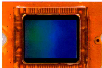
▲不论哪个品牌，所有 4/3 制式机身的感光元件都采用了统一的尺寸，全部皆为 17.3×13mm 大的感光范围。
