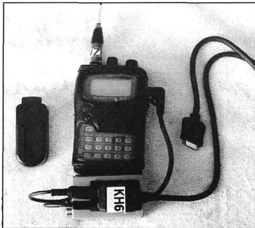
图 1.4 VX-5R 到 VCH1 的装置。接口盒包含相互链接的跳线，以用于设备的变更。话机插头的功能增加，可以支持许多收发器设备。
