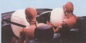
汽车的安全气囊位于方向盘内。
