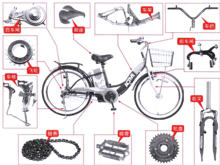
图1-1 电动自行车机械系统
