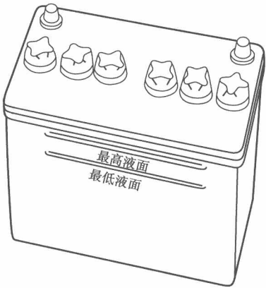
图2-2 电解液液面高度的检查
