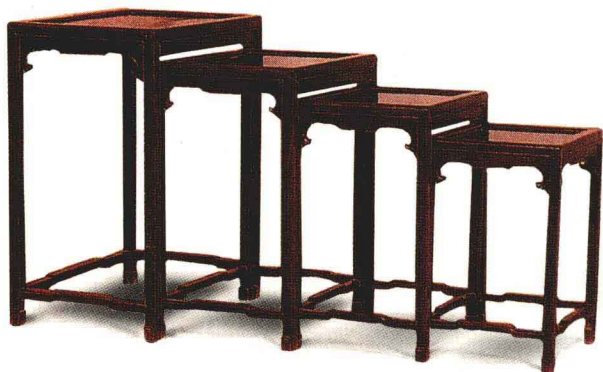
清晚期·红木四联套几 尺寸：五二厘米×三六厘米×六五厘米（最大几） 几面为攒框落堂装板，面板下装云纹牙板。面板与腿足间为棕角榫结构，直腿内翻卷云纹马蹄。腿足间安罗锅枨。
