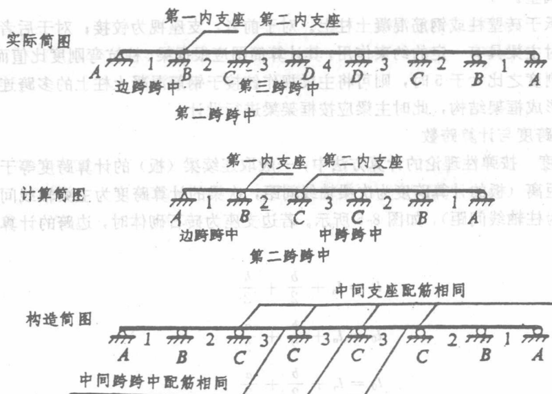
图 8-6 多跨连续板、梁的计算简图和构造简图
