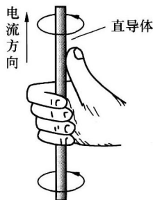
图 1-6 用右手螺旋定则判断通电直导体的磁场方向
