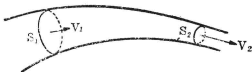
图 1—2 液流连续原理
