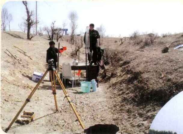
渠道一维有压入渗试验
