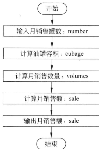
图 1-1-2 计算加油站月销售额程序流程图
