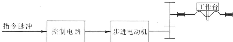
图 1-2 开环控制数控机床的工作原理图
