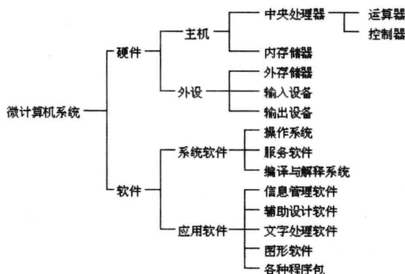
图 1.1 微型计算机系统的组成框图
