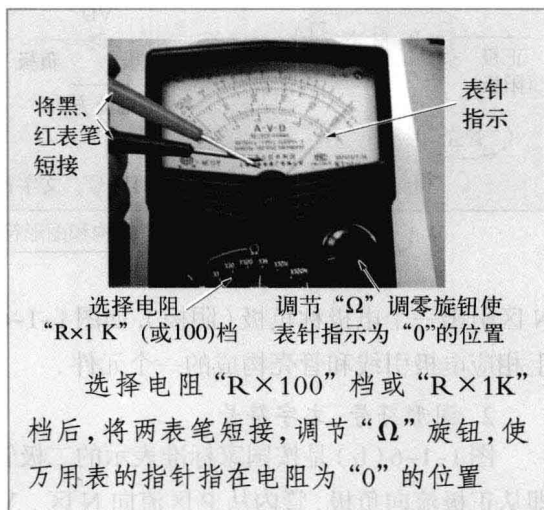
图1-1-4 万用表选择 \Omega 档与选用量程档调零
