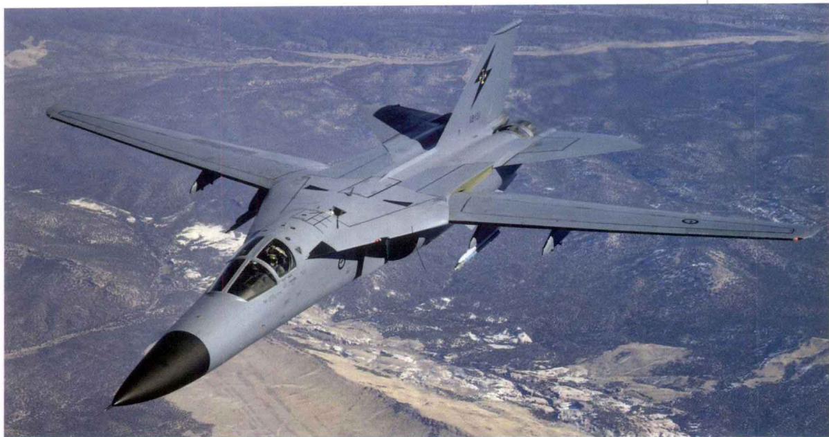
图 1-4 F-111 战斗轰炸机是世界上第一种实用型变后掠翼飞机
