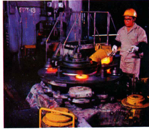
傳動裝置 環形齒輪鍛造的輻壓機
