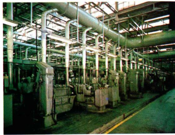
藉著自送聯製機械加工的汽缸體
