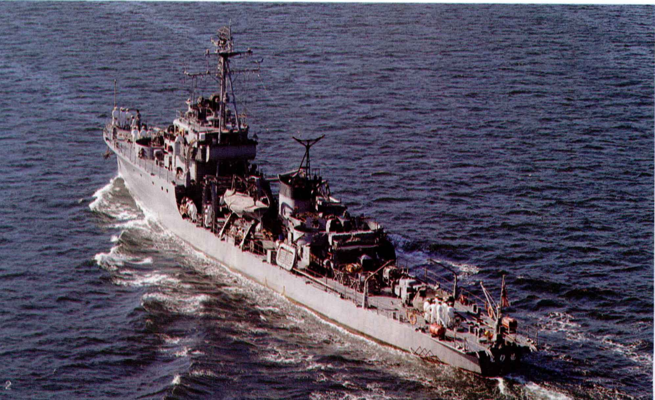
↓ 布雷艇“襟裳”号 Erimo 该艇根据日本1953年度计划建造，1955年12月竣工。该艇是一艘能遂行水雷布放、扫雷、反潜任务的多用途小型水面战斗舰艇。照片是1975年10月21日该艇通过早濑瀬户时的情景。从照片上可以清楚地看到特征明显的后甲板配置。该艇当时配属于第1扫雷队群。
