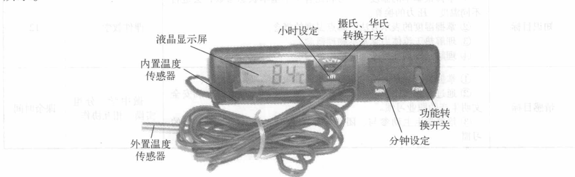
图 1-1 数字温度计结构
