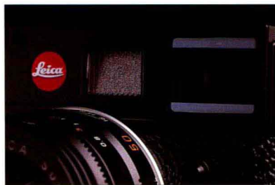
▲ M9的0.68x取景器，沿用M系列出色的连动测距式设计，其内设3组亮线框，能完全配合135全画幅影像传感器；加上自动修正功能，取景器在不同对焦距离时，能提供较准确的景物涵盖指示，令摄影师拍摄时更有把握。
