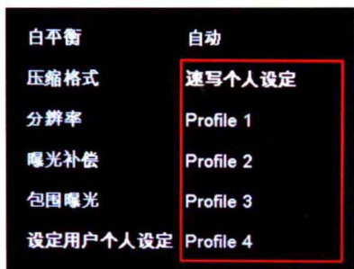
▲ M9用户仍可以在按设定 (SET) 键后设置用户个人设定，其中包括一个简化拍摄的速写个人设定，让相机的自动化功能发挥出来，摄影师可专注拍摄。
