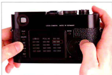
▲ 按住ISO键，然后再按动方向键或转盘，便可快速设定所需的ISO感光度。
