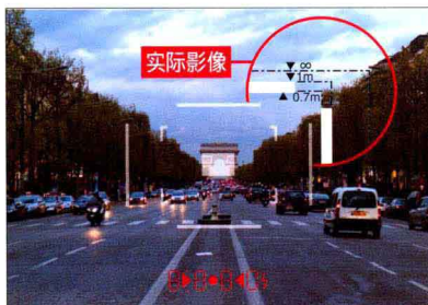
▲ 在不同对焦距离时，实际拍摄的景物范围会与亮线框所涵盖的有少许不同。
