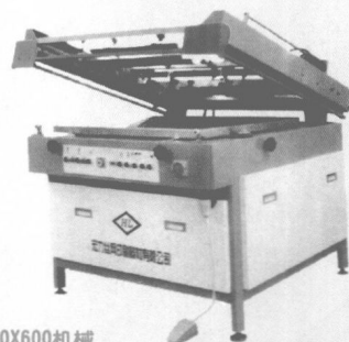
SHL900X600机械 气动平面丝印机
