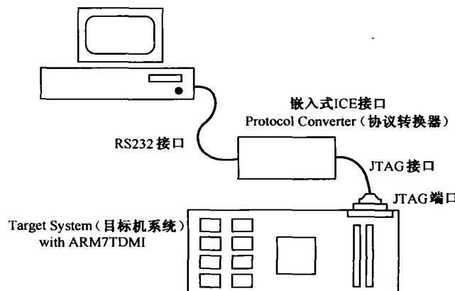
典型的ARM调试系统主要分为三部分：调试主机、协议转换器（调试代理）、目标机系统（调试目标）。调试主机一般是一台运行调试软件（如ADS）的计算机。调试主机可以发出一些高层的调试命令，如设置断点、访问内存等。
