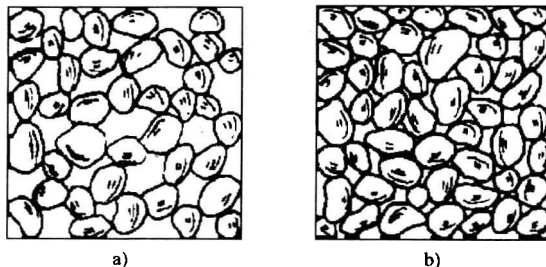
图 2-8 土的单粒结构 a) 疏松的 b) 紧密的
