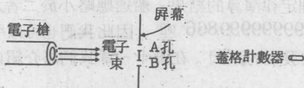
圖 1-2 一電子槍所射出之電子束通過 A 孔及 B 孔
