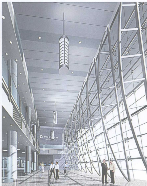
点支式玻璃幕墙局部（二）
