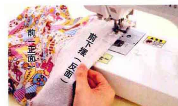
⑤ 缝合下摆与身片，使用弹性针迹车缝。
