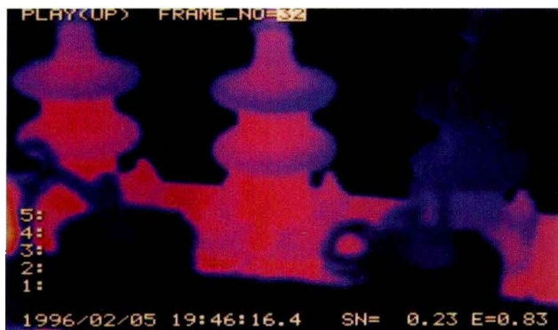
图 H10 变压器低 压侧纯瓷套管因充 气而缺油
