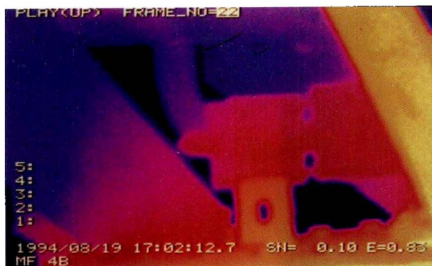
图 H7 气体继电器 阀门未打开
