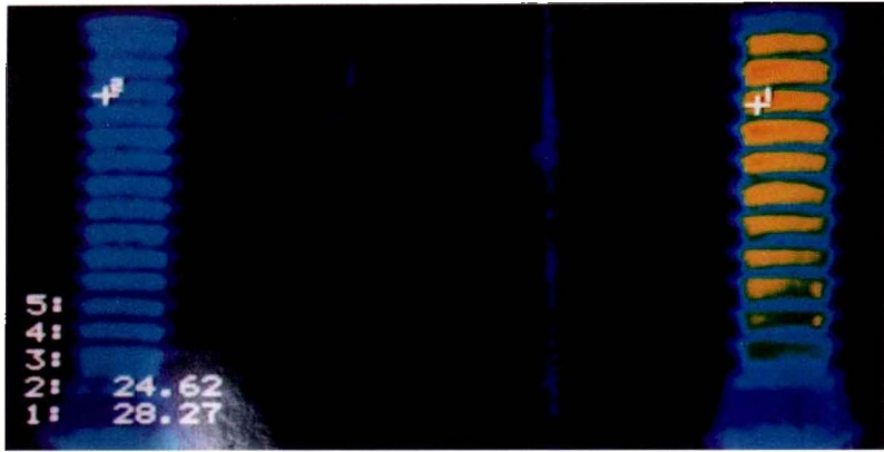
图 H31 110kV 耦合电容器内部 损耗异常
