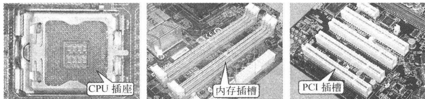
图 1-5 主板中重点插槽的实物外形
