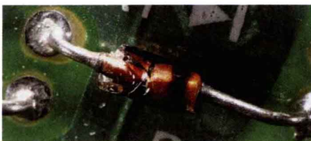
图1.1 有引线的圆柱电阻器电阻体崩口
