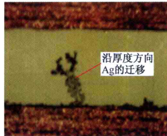
图1.14 \text{Ag} 离子沿绝缘基板表面方向的迁移现象 图1.15 \text{Ag} 离子沿绝缘基板厚度方向的迁移现象
