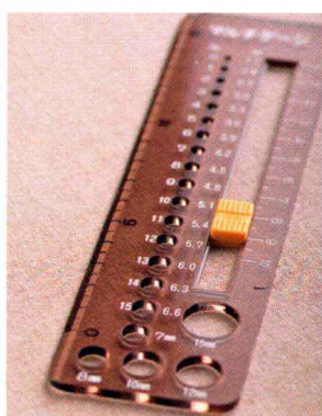
量针尺 一般棒针或环形针都有标示针号尺寸，但使用久了容易脱落，此时可用量针尺测量棒针或轮针大小。
