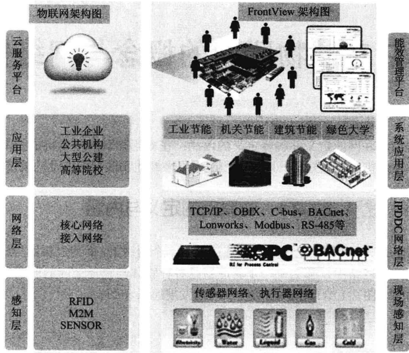
图 1-4 物联网节能应用总体架构图
