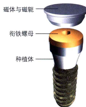
图 2-4 应用于种植体的磁性附着体结构
