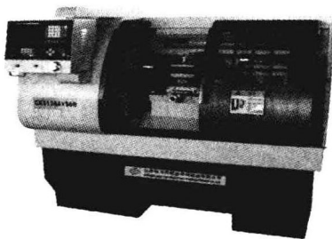
图 1-9 卧式数控车床
