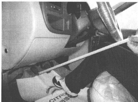
图 1-30 不踩离合器踏板测量 L_1
