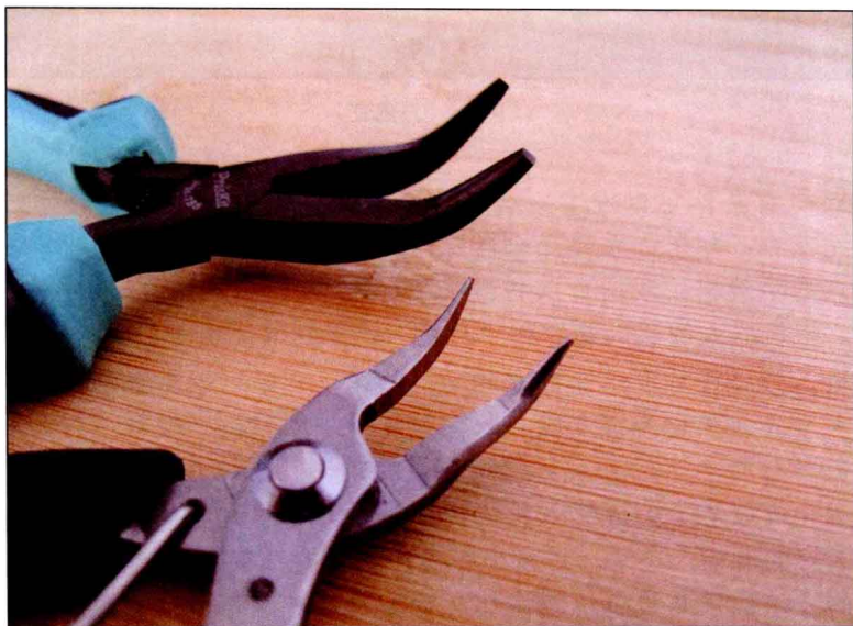
图1-8 弯头尖嘴钳，镊子的理想替代品
