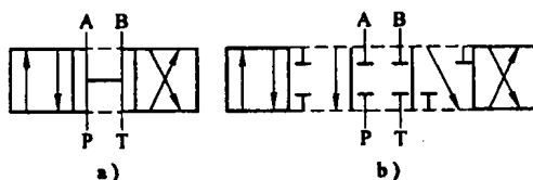
图 4-2-12 滑阀式换向阀的过渡机能
