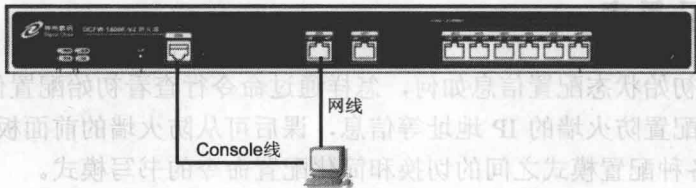
图 1-5 防火墙配置连接
