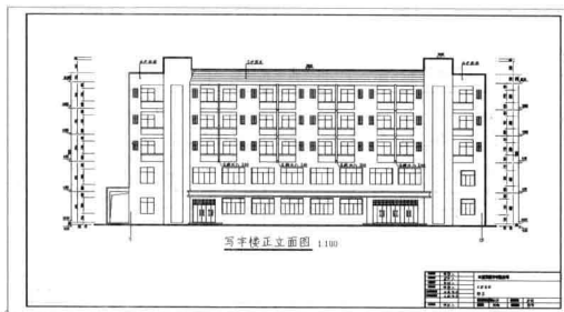
图 1-2 AutoCAD 绘制的建筑立面施工图
