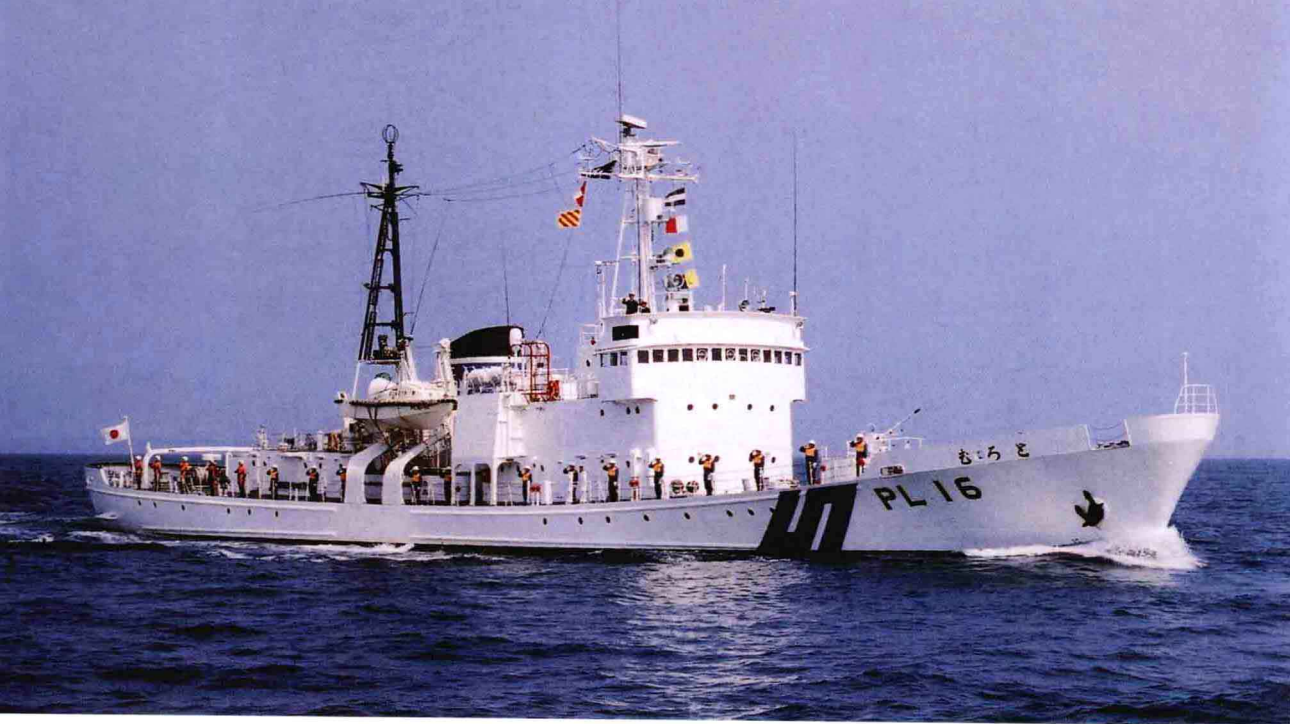
↑大王型 Daio (室戸 Muroto PL-16) 大王型巡视船是“襟裳”型的改进型，公称船型是改2-900吨型，在1973年、1974年各建成1艘，分别于2001年、2005年退役。为了提高减摇效果，本型船将减摇水舱从船体内部改为设置在船桥构造物后部，并略微增大了船体宽度。此外，从本型巡视船开始，日本海上保安厅的巡视船即使不是配备在北方地区，船体也都采用耐冰构造。本型巡视船总吨数939吨，正常排水量1194吨，全长76.6米，速度20节。本型船因率先采用了大型巡视船才有的可变距螺旋桨而闻名。武器装备包括40毫米单管机炮和20毫米单管机炮各1门。第二艘本型船由于配备在南方地区，全船装备有冷气设备。照片拍摄于2003年。
