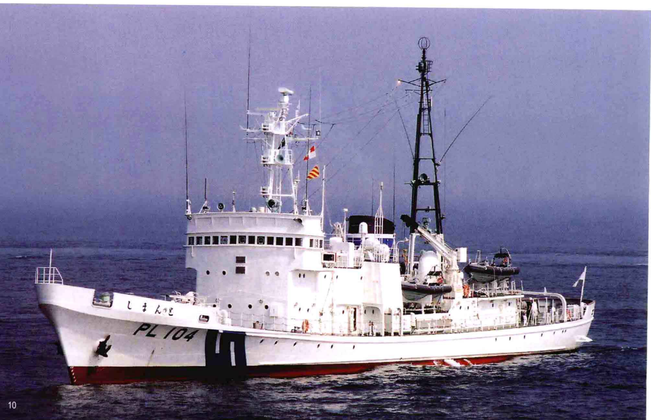
↓知床型 Shiretoko (四万十 Shimanto PL-104) 日本海上保安厅以1977年的新海洋秩序为契机，在短短4年时间内，共建造了28艘知床型巡视船。这些巡视船分别于1978-1982年竣工服役。本型船根据“大王”型巡视船改建而成，公称船型是1000吨型。船艏的外张部变大，不仅提高了航海性能，还提高了居住性能，并努力采取措施节省人力。2000年以后，本型船共有16艘退役，目前在役12艘。本型巡视船总吨数965吨，正常排水量1200吨，全长77.8米，速度20节。武器装备包括40毫米单管机炮和20毫米单管机炮各1门。各船除在武器装备方面有所不同外，有的巡视船在服役后还对武器装备进行了调整。
