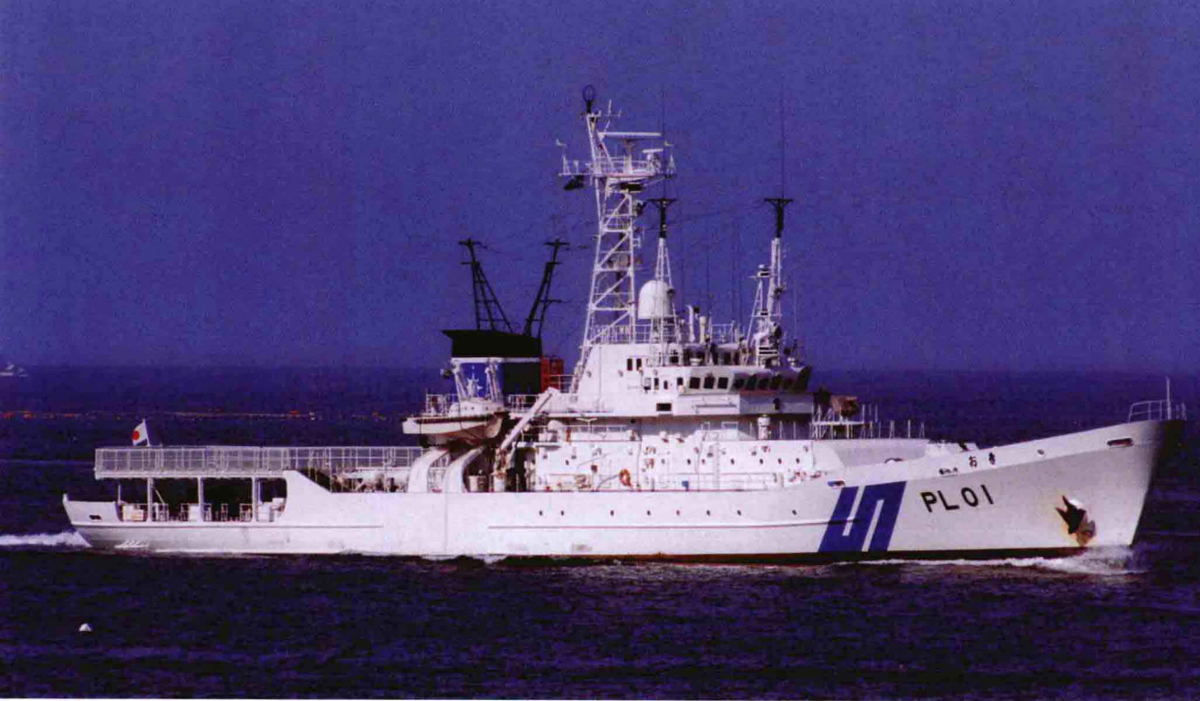
↑“野岛”号 Nojima PL-01 “野岛”号巡视船是重视救难业务，设置有直升机起降甲板的1000吨型原型船，没有同型船，1989年竣工。1997年，“野岛”号的船名改为“隐岐”号 Oki。照片拍摄于船名变更后的1999年。本船的特征是虽然没有直升机机库，但具有补给航空燃料的能力，能够作为海上基地支援直升机的行动。此外，本船装备有由水下探测机器人（ROV）和声呐构成的救难系统，在船桥正后方半甲板高的位置设有OIC室。本巡视船总吨数993吨，正常排水量1500吨，全长87.0米，速度20节，武器装备为20毫米多管机炮1门。
