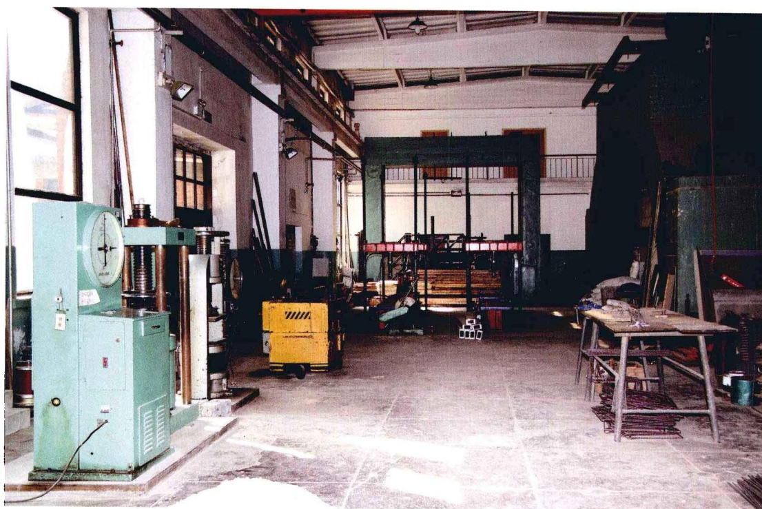
结构试验厅(2), 12m×42m, 教学试验台座 4m×10m, 拱形试验台 4m×8m, 混凝土框架 4m×4m
