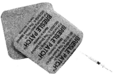
图 1-2 测定表面上残留的可溶性盐类浓度的贴片和注射用针
