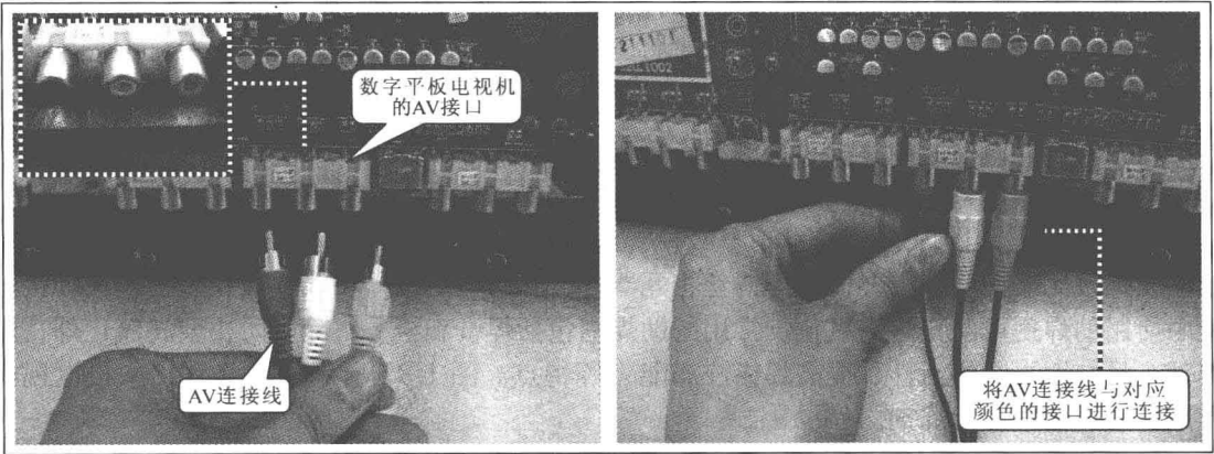
a) 将AV连接线端口与数字平板电视机的AV接口进行连接
