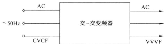
图 1-15 交-交变频器的工作原理
