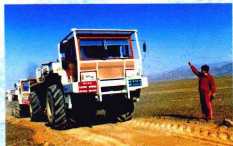
大吨位震源施工
