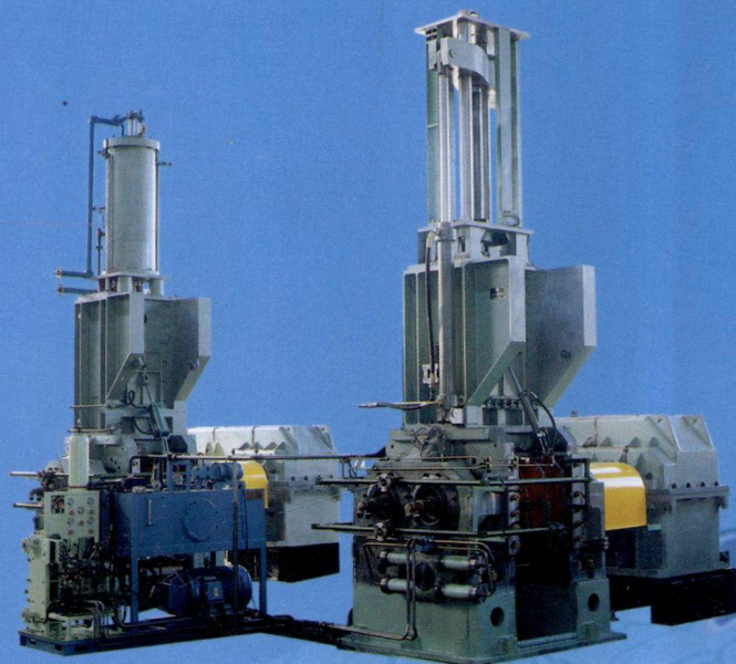
密闭式炼胶机 —有特别适用于生产子午胎的液压上顶栓、啮合型转子、同步转子、六棱（三角）型转子等配置。
