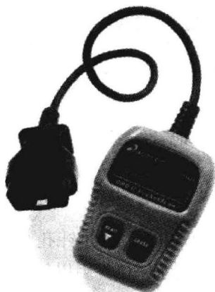
图 1-2 一个常见的共享故障码读码器
