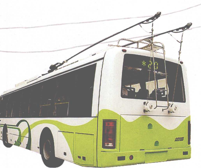
无轨电车上都有两根“长辫子”。
