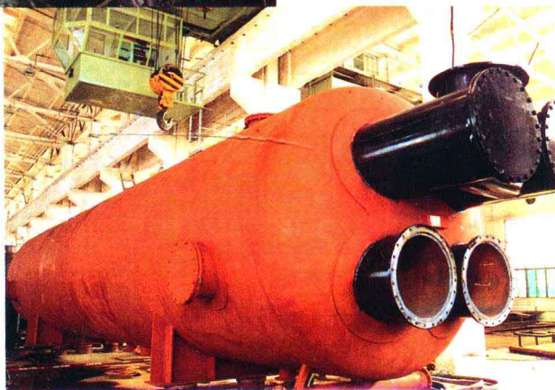
机械厂制造的 200 万大卡加 热炉
