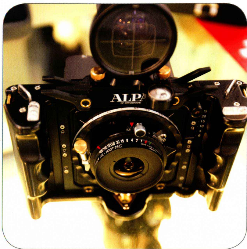
Schneider (施奈德) 为ALPA设计的数码镜头的样品, 主要用于数码后背的使用。
