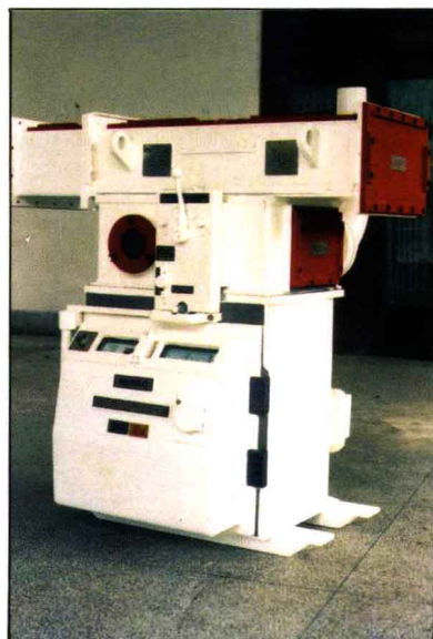
②引进英国 GEC 公司和德国 Bender 公司 技术生产的 MIVAC-3.6S1 矿用隔爆 兼本安型高压真空配电装置
