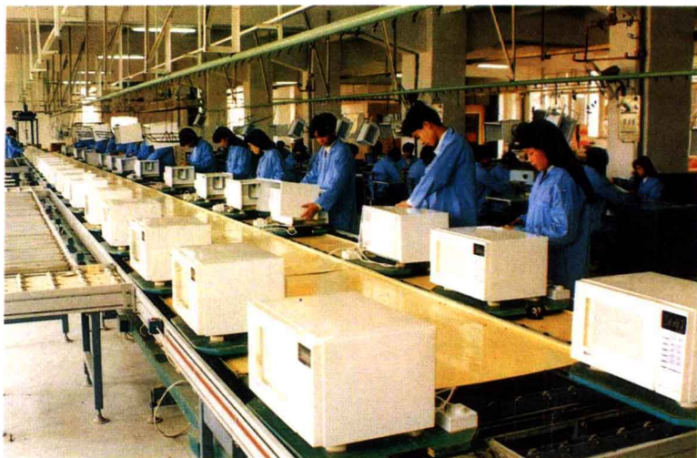
年产 30 万台微波炉生产线总装工段
