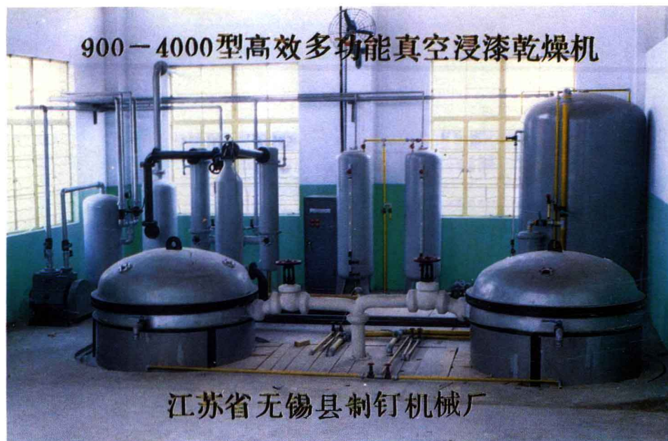
1600型高效多功能真空浸漆干燥机
